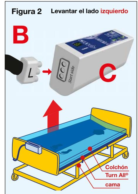
Si el ascensor debe comenzar en el lado izquierdo de la cama, visto desde el extremo de los pies, la conexión de la manguera con la letra “L” se gira hacia el texto “Lado de inicio” en la bomba, como se muestra en (Figura 2).
