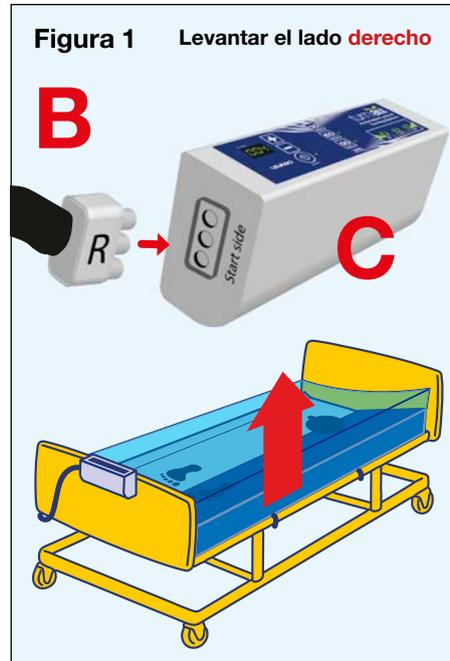
Si el ascensor debe comenzar en el lado derecho de la cama, visto desde el extremo de los pies, la conexión de la manguera con la letra “R” se gira hacia el texto “Lado de inicio” en la bomba, como se muestra en (Figura 1).
